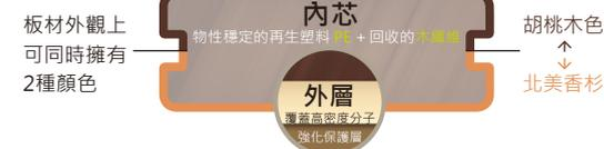
產品採用先進的共擠成型技術，將外保護層與內芯層完美結合，完全不依賴黏合劑，不僅確保產品的結構完整性與環保特性，也徹底避免了表層剝落或分離的問題，同時大幅提升整體結構的強度與耐用性，展現出 Doozer Wood 在長期使用中的穩定性能。不同工廠之間的生產能力、技術精確度與操作熟練度各有差異，即便生產相同的產品，工藝流程往往也會有所不同。然而，Doozer Wood 始終專注於技術創新，致力於結合美感與材料處理的精湛技術。我們勇於挑戰材料的極限，創造出獨特且卓越的產品，為客戶提供超乎期待的品質與可靠性。
